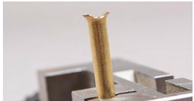
Abb.: Schmierröhrchen 3.3 rund feilen zum Anlöten
