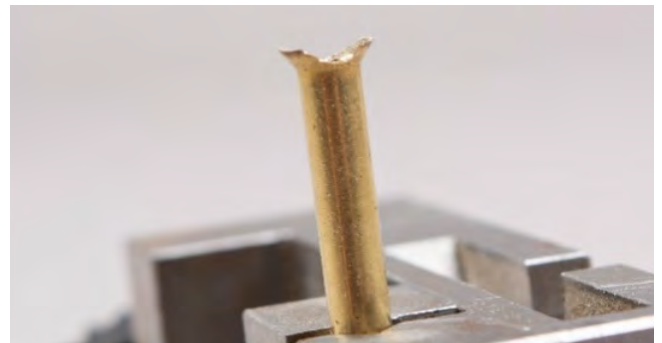
Vue : Limez les tubes de graissage 3.3 pour souder
