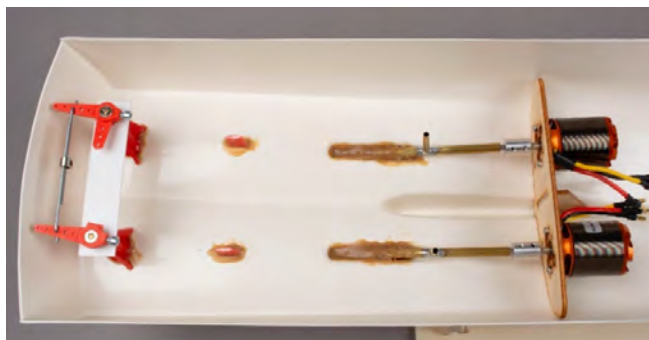
Vue : Propulsion avec moteurs brushless Max Marine P365
