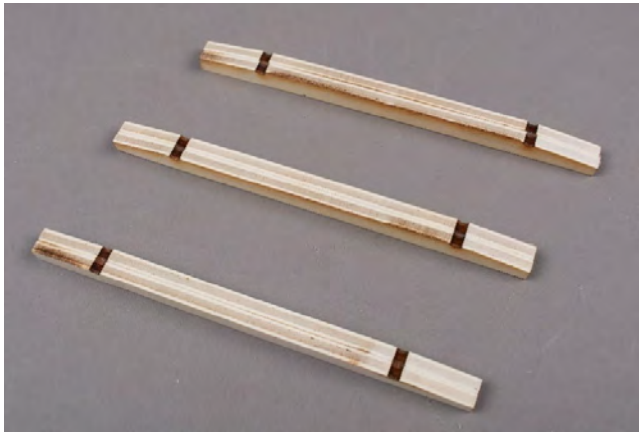
Abb.: Je 2 Unterzüge 4.2 verkleben
