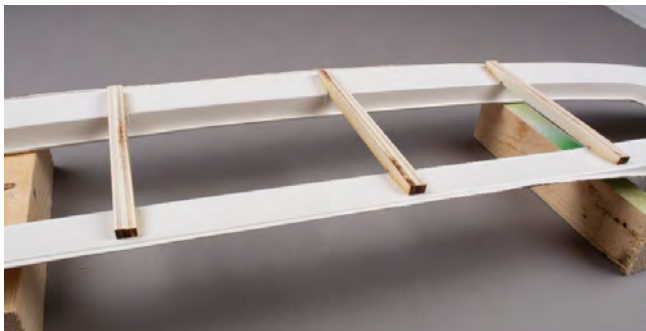
Vue : Renforts de pont
