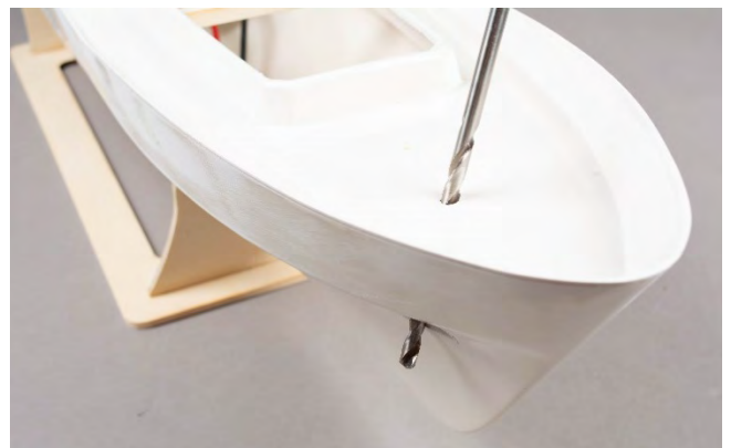
Abb.: Bohrung für Ankerfallrohr
