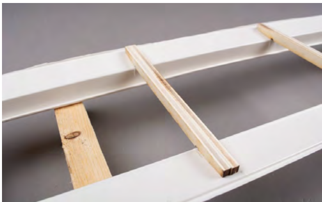
Vue : Ajustage des renforts de pont
