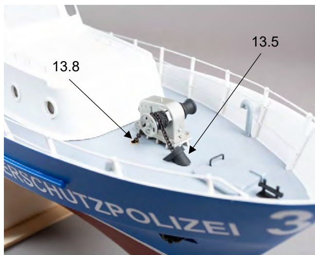
Vue : Etrave avec treuil d'ancre et écoutille
